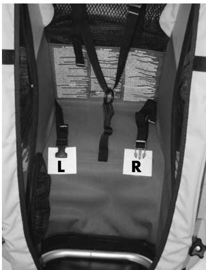
Innenansicht des Sitzplatzes mit seitenrichtig montierten Abspannsteckern.
