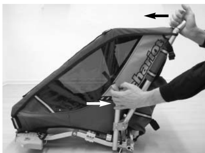
Aufbau der Basis: Mit der linken Hand die Achsaufnahme nach unten, mit der rechten Hand das linke Rahmenrohr nach oben drücken. Danach mit der linken Hand das kurze gebogene Rohr nach hinten ziehen. Vorgang auf der rechten Seite wiederholen. Wenn Sie das kurze gebogene Rahmenrohr nach hinten ziehen, muss die Aufbauarretierung hörbar einrasten.
