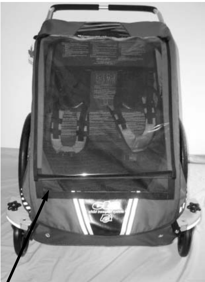
Wetterverdeck zur besseren Durchlüftung teilweise hochgeklettet..
