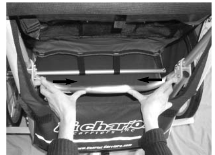
Zum Falten der Basis müssen Sie beide Knöpfe gleichzeitig auslösen und den W-Bügel nach vorne drücken.
