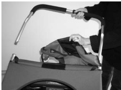
Um das Wetterverdeck ganz abzunehmen, muss der Schiebebügel abgenommen werden.
